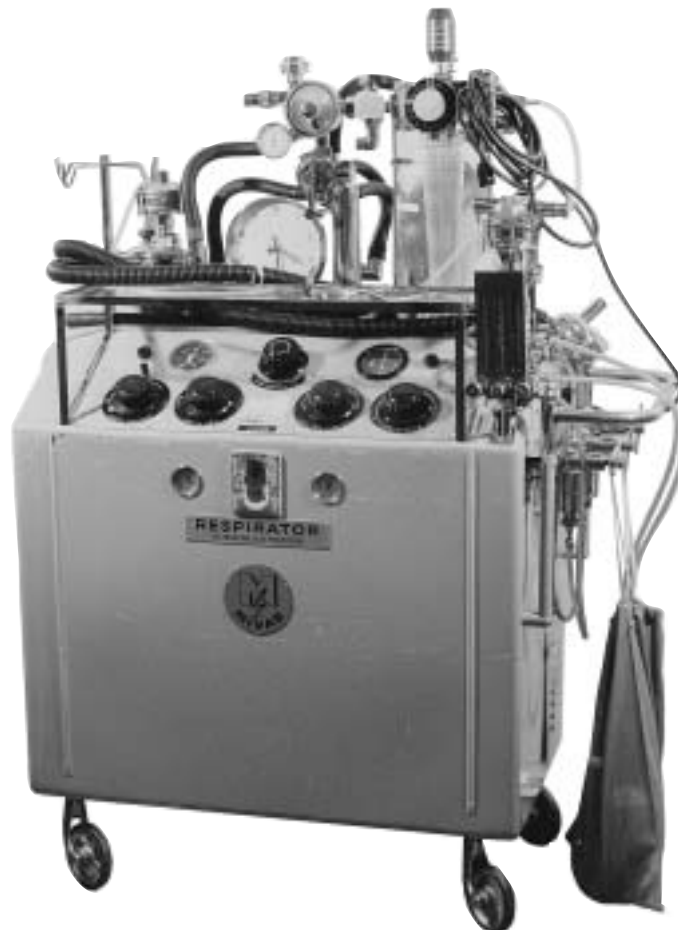
Respirator nach C. G. Engström, Modell 150, hergestellt von der Firma Elektro-medicinska apparater, Stockholm/Schweden, 1967.
